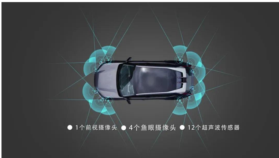
ADiGO PILOT 智能駕駛系統覆蓋八大冗餘系統和功能安全設計
