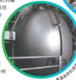
高温染色机表面喷涂工业隔热保温涂料
